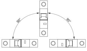
**Рис. 1.** Рабочие положения выключателя автоматического серии BA47-60
