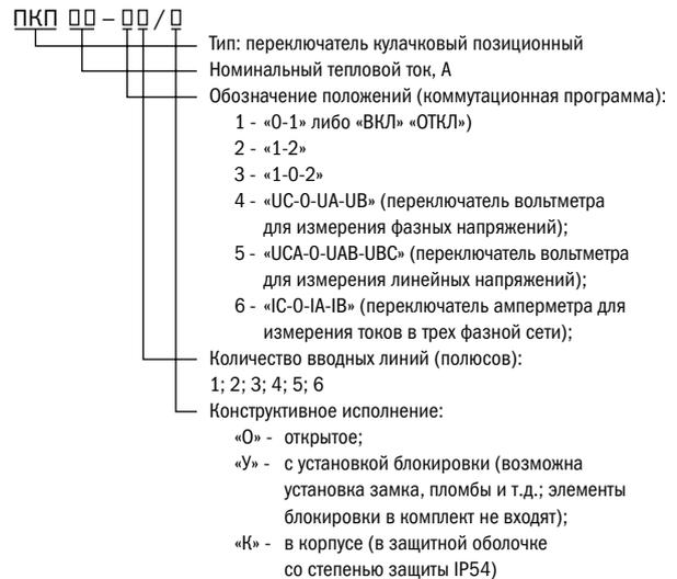
Рис. 1 Структура условного обозначения кулачковых переключателей
