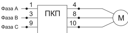
Рис. 4 Реверсивное включение электродвигателя с помощью ПКП
