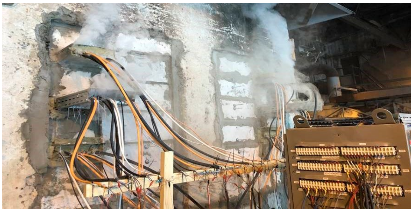
Испытания огнестойкой кабельной линии в лабораторных условиях
