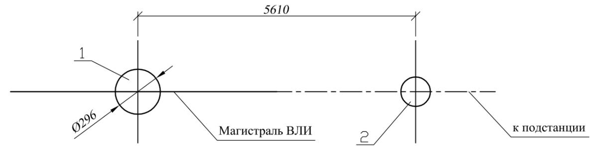
Схема установки опоры на ВЛИ
