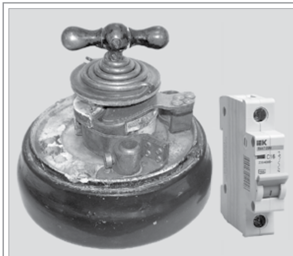
Выключатель производства Великобритании конца XIX века с коммутируемым током до 15А при напряжении ~220V. Сечение присоединяемого проводника может достигать 50мм 2 . Рядом – выключатель автоматический ВА47-29 ТМ IEK.
